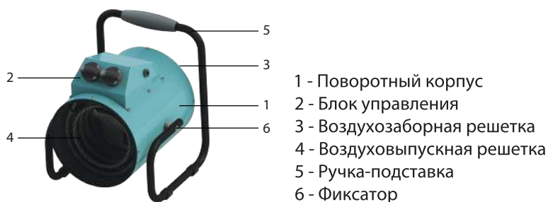
Рис. 1. Устройство прибора
