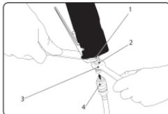
Закрутите патрубок для присоединения шланга (2) на входной штуцер (1), придерживая входной штуцер рожковым ключом (3). Подключите шланг подачи воздуха (4) к инструменту.
