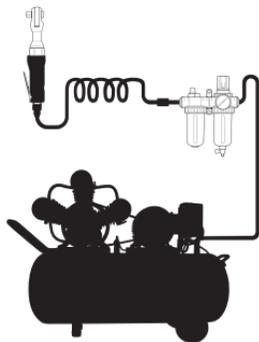
Sämtliche Steuerelemente, Verbindungsleitungen und -schläuche müssen für den Solldruck und Luftvolumenstrom ausgelegt sein. Vermeiden Sie die Verengung der Zuführungsleitungen, z.B. durch abgequetschte, geknickte bzw. ausgedehnte Stellen. Vor dem Anschluss des Schlauches an den Werkzeug blasen Sie den Schlauch regelmäßig aus, um Reste der Feuchtigkeit aus dem Schlauch zu entfernen.
