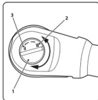
Überprüfen Sie die eingestellte Drehrichtung. Zum Festziehen von Schrauben und Muttern drücken Sie die Regulierschraube in Richtung F durch (Forward / Rechtslauf). Zum Lösen von Schrauben und Muttern drücken Sie die Regulierschraube in Richtung R durch (Reverse / Linkslauf).
