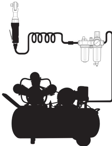
**ПРИМЕЧАНИЕ:** Перед первым использованием инструмента нанесите на входное отверстие 4-5 капель масла перед подключением шланга.
