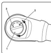
Проверьте установленное направление вращения. Для закручивания винтов и гаек поверните переключатель направления вращения (1) в направлении F (3) (Forward/вперед).
