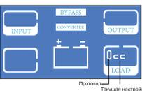
6) Настройка протокола: нажмите ON/OFF режим выбора и войдите в настройки протокола. Нажмите кнопку FUNC, чтобы изменить протокол. Первое значение: 0-Modbus, 1-СНТ "CC" - текущий протокол.
