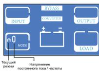
5) Установка режима: Нажмите кнопку ON / OFF, чтобы выбрать частоту и войдите в настройки режима, нажмите кнопку FUNC, чтобы изменить режим. Первое значение: N-нормальный режим, режим E - ECO. Второе значение: указывает текущее напряжение/частоту.
