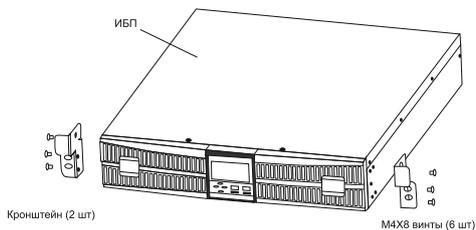
5.1.1 Закрепите два кронштейна винтами M4x8 как показано на рисунке 3.
