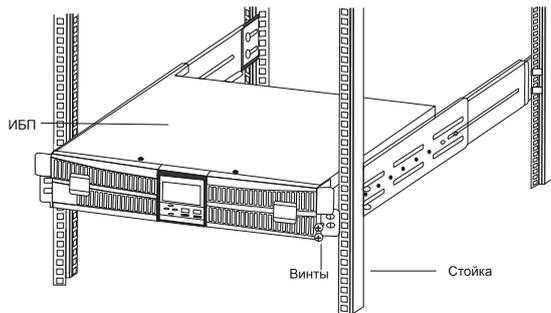
5.1.2 Поместите ИБП на направляющую в стойке, и задвиньте его в стойку. Зафиксируйте ИБП с помощью винтов через отверстие в кронштейне, как показано на рисунке 4.
